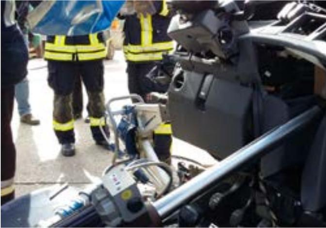
Der zweite Seminar-Tag stand ganz unter dem Motto: praktische Ausbildung. Erster Punkt war die Einrichtung eines Ablageplatzes mit verbundener Gerätekunde. Mit einem Betongewicht hatten die Fahrzeuge eine „neue Form“ bekommen und auch die Fahrertüren wurden mit zwei Gabelstaplern kräftig verformt. Ziel dieser Maßnahmen war es Spannungen und Verformungen zu erzeugen, wie sie auch an echten Unfallfahrzeugen anzutreffen sind.
